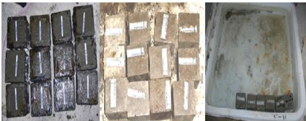
شکل ۳- روند بتن ریزی و قرار دادن آن‌ها در حوضچه آب
